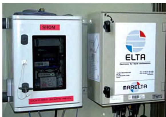
**Le télémètre radar (à G) et sa centrale d'acquisition (à D)**
