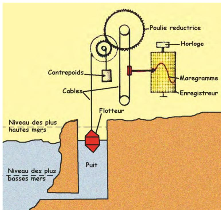
**Principe de fonctionnement du marégraphe**
